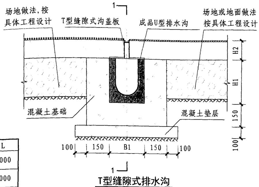
T型缝隙式排水沟
