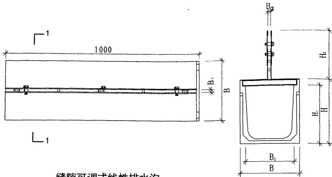
缝隙可调式线性排水沟
