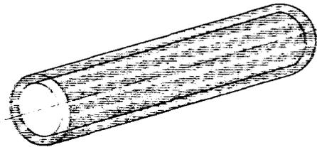
塑笼式透水管结构形式简图
