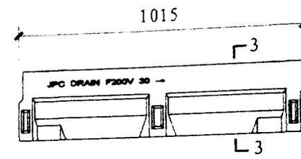
一体型树脂混凝土排水沟立面图
