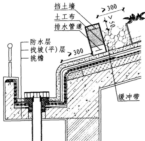
坡屋面种植土挡墙示意图(2)
