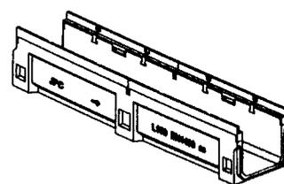
L型树脂混凝土排水沟轴测图
