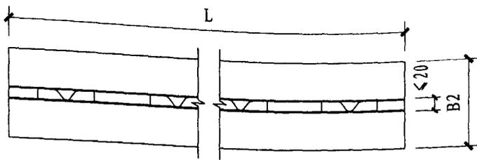
T型缝隙式沟盖板平面图
