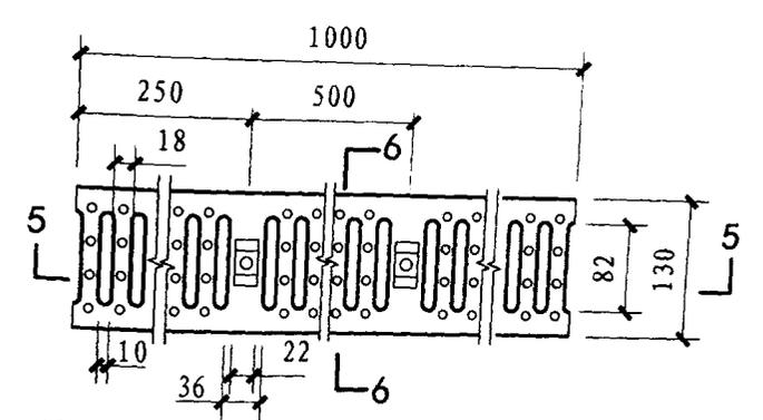
BZP100-15-02型冲压式盖板平面图
