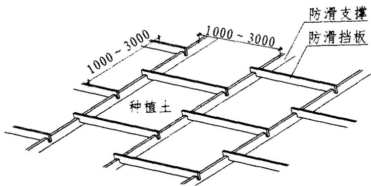
坡屋面种植防滑设计基本构造(1)
