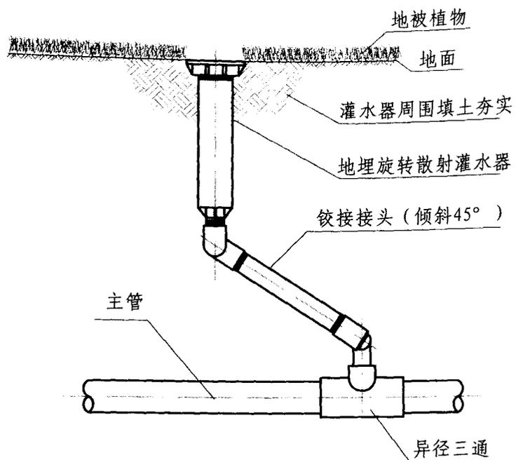
地埋旋转散射灌水器安装示意图
