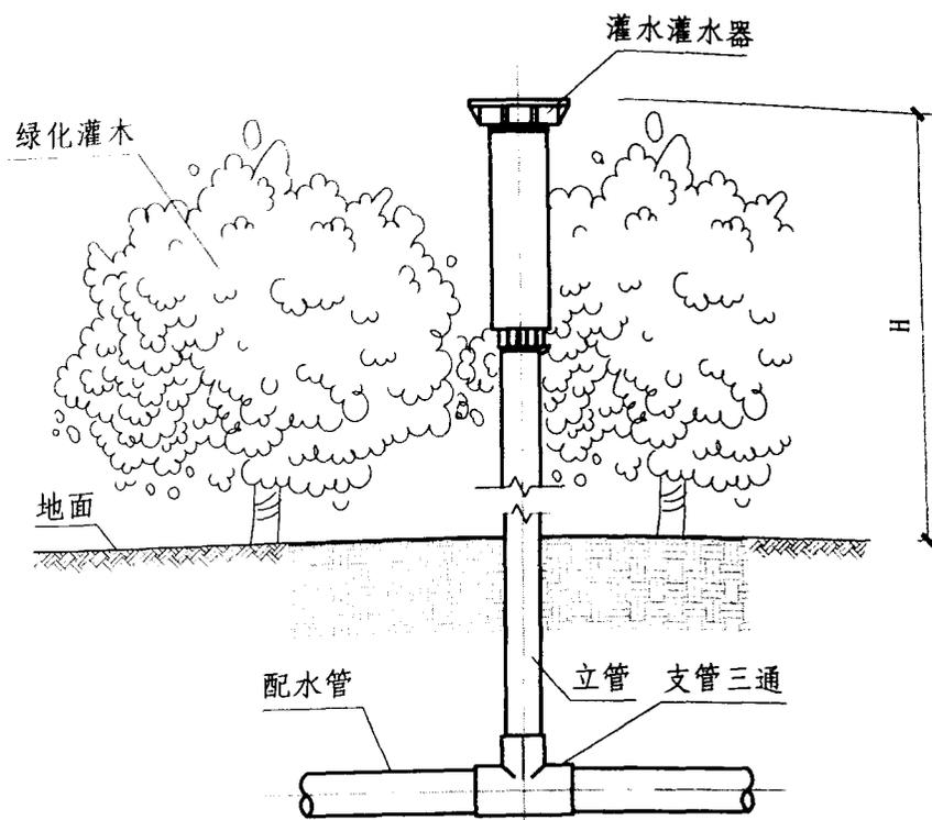
灌木丛型灌水器安装示意图
