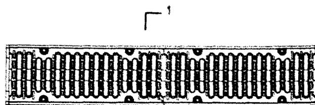
L<sub>1</sub> 铸铁沟盖板
