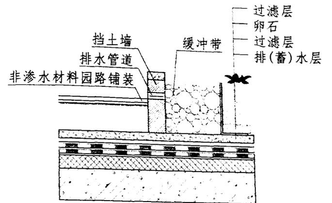
建筑顶板满铺排水板示意图 (3)
