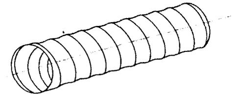
钢塑软式透水管结构形式简图
