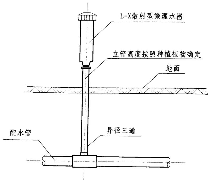
散射微灌水器安装示意图
