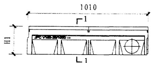
V型树脂混凝土排水沟立面图
