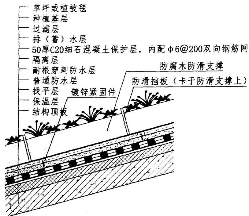
坡屋面种植设计基本构造层次示意图(3)
