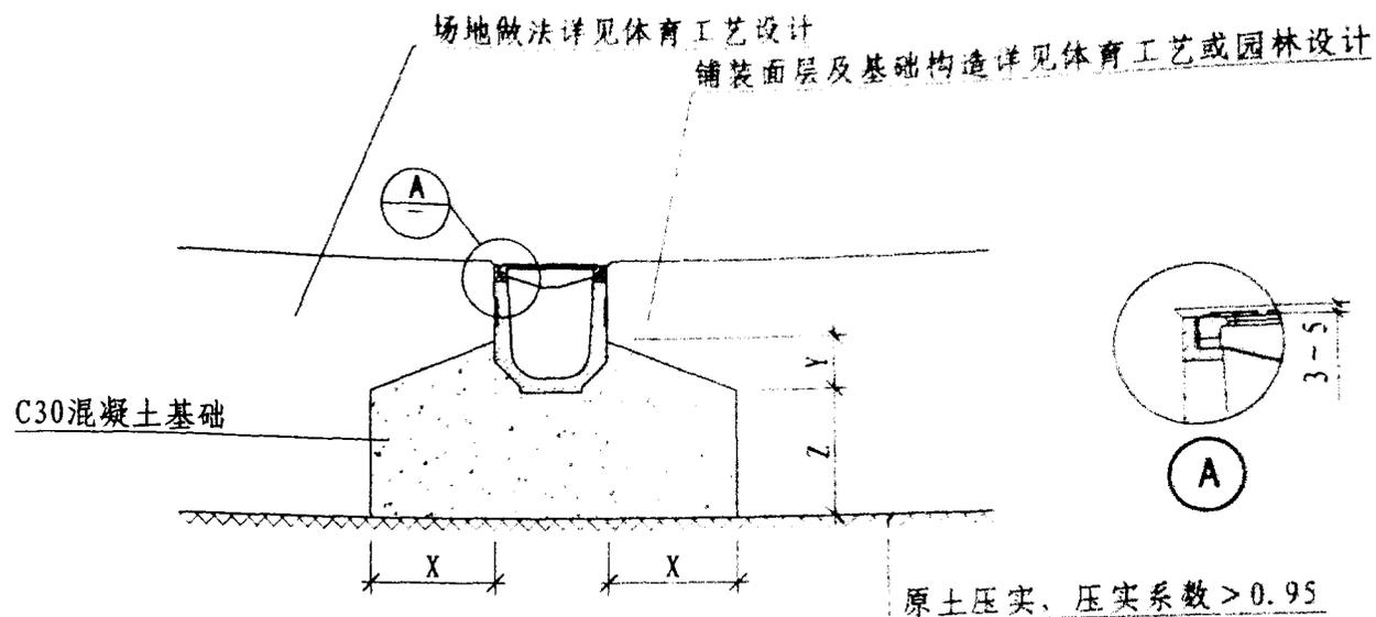
树脂混凝土排水沟安装图
