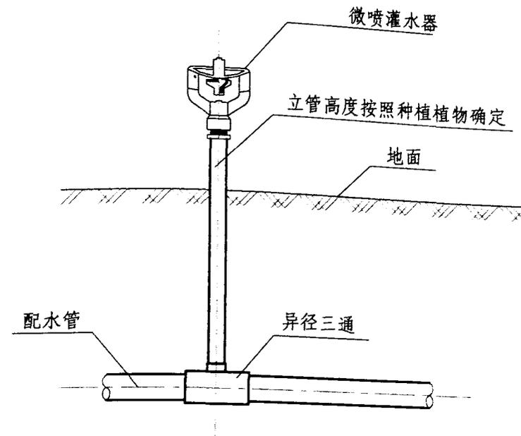
微喷灌水器安装示意图
