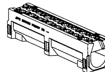
一体型树脂混凝土排水沟轴测图
