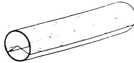
HDPE穿孔渗排水管结构形式简图
