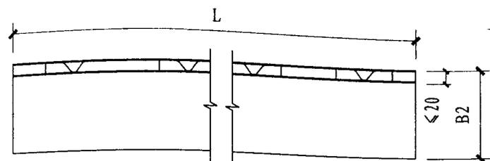
L型缝隙式沟盖板平面图
