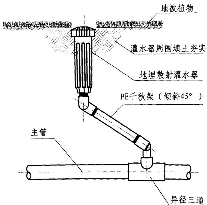
地面散射灌水器安装示意图
