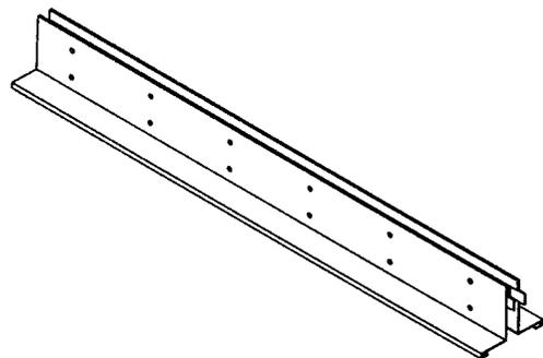
中缝式排水沟盖板轴测图
