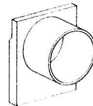
连接管件 (DT150-20230. 4) 轴测图
