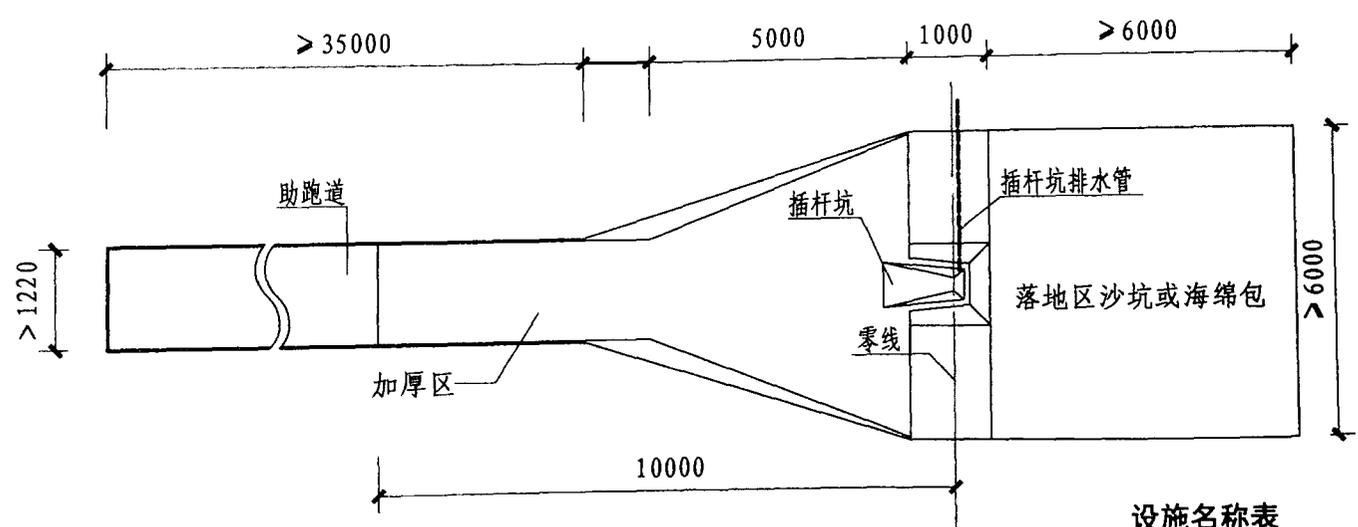
撑杆跳高插杆坑平面图
