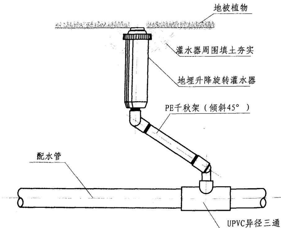
大型埋地升降旋转灌水器安装示意图
