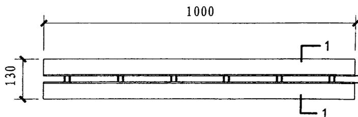
中缝式排水沟盖板平面图
