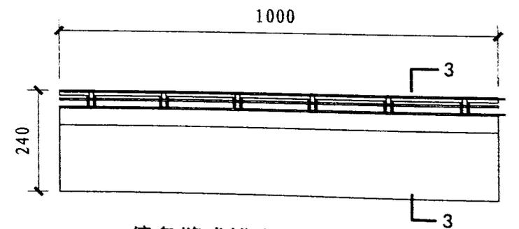
偏多缝式排水沟盖板平面图
