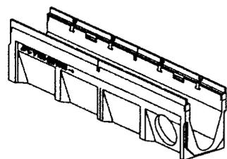
V型树脂混凝土排水沟轴测图
