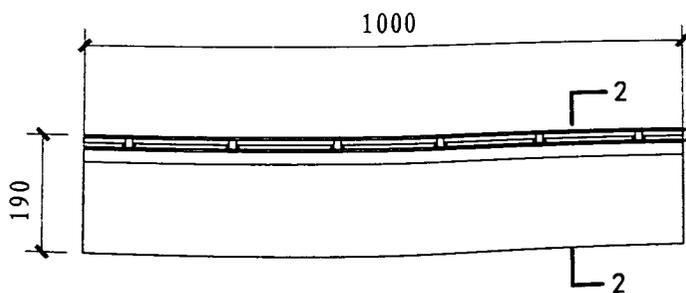
偏单缝式排水沟盖板平面图
