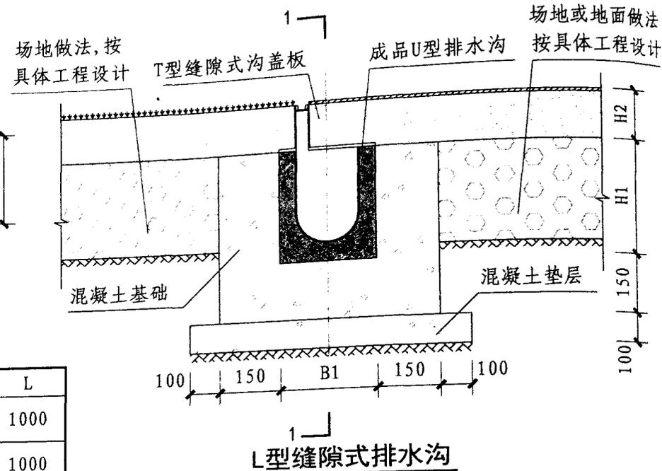
L型缝隙式排水沟
