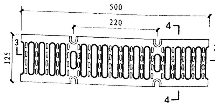
BZCI 1250F900型铸铁沟盖板平面图
