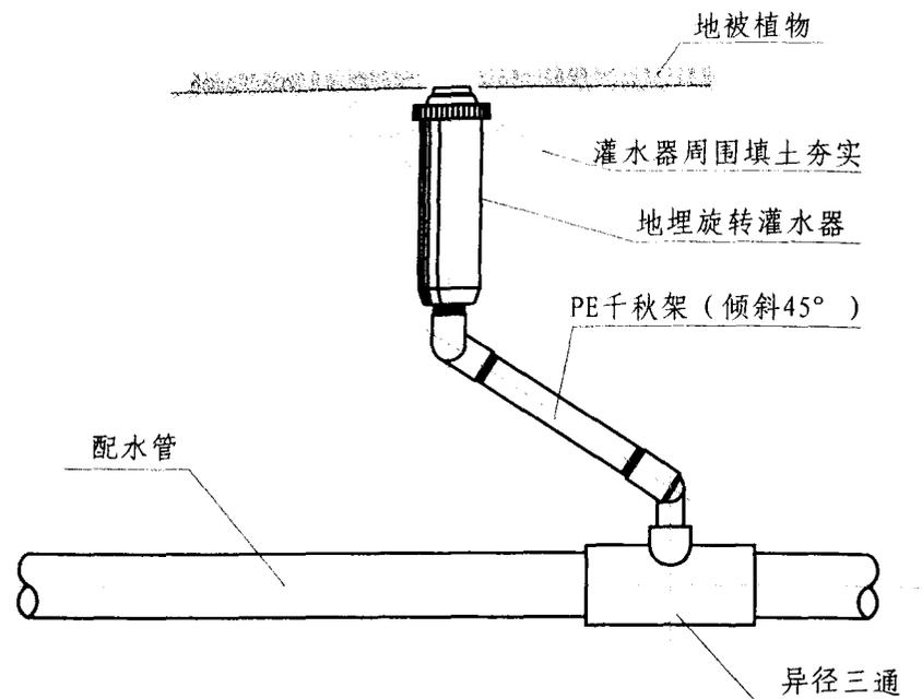
中小型埋地旋转灌水器安装示意图
