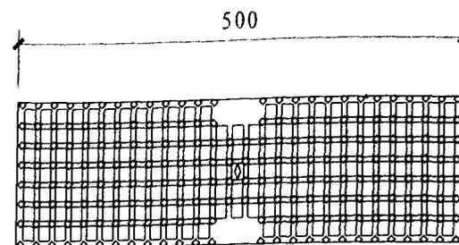
**球墨铸铁网格式盖板**
