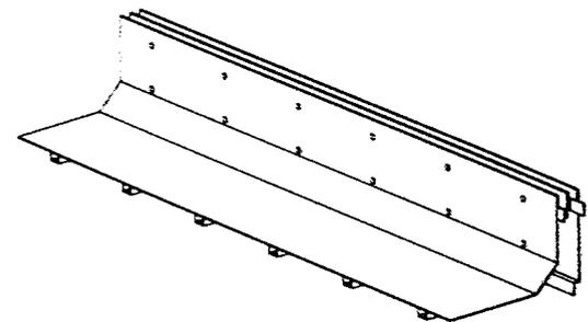
偏多缝式排水沟盖板轴测图
