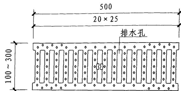
**球墨铸铁沟槽式盖板**
