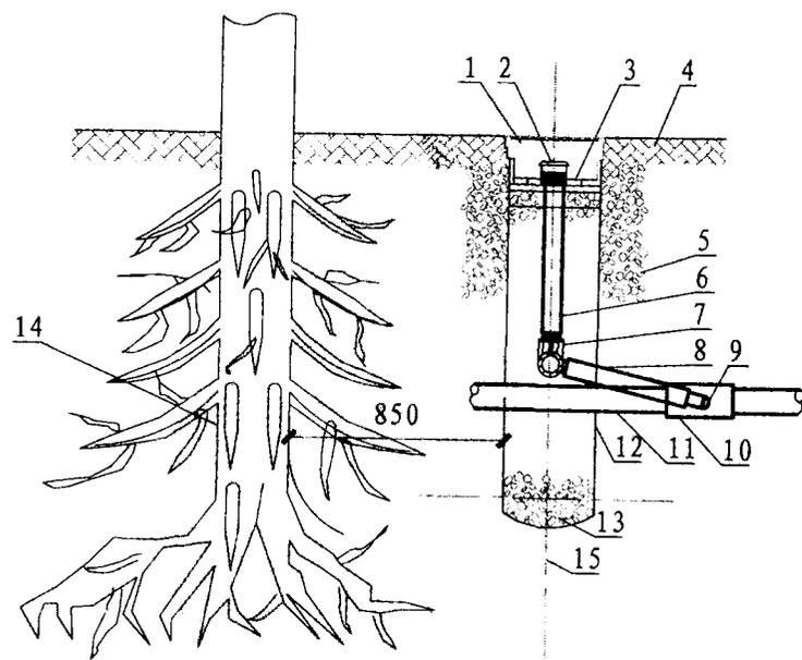
根部灌水器安装示意图
