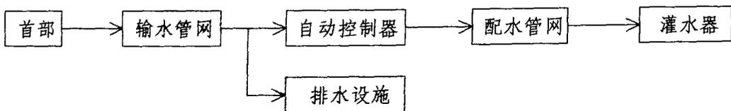
1) 首部系统: 由水源水池、加压泵站、水过滤设备(可选)、用水计量设备、施肥设备、过滤器及相应配套阀门、附件、仪表等组成。
