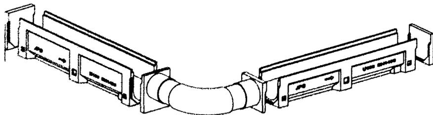
不同沟深转弯转换组合件轴测图
