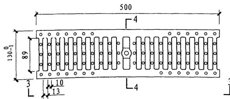
BZCI 130C250型铸铁沟盖板平面图
